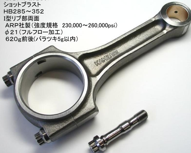
高回転時に要求させる強力な引っ張り応力に対応するため従来のクロモリ軽量コンロッドのボルトに変更を加えたタイプIIコンロッドがリリースしました。ボルトは強度的に信頼性の高いARP社(USA)に特注した下ボルトタイプでナットを使用せずロッド本体にネジを切ることにより緩やかな肩形状が可能になり、大端部まわりの強度を確保します。
