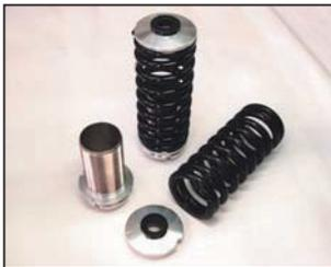
※純正のパネの受け皿を削り取り、車高調アジャスターをかぶせて溶接します。
