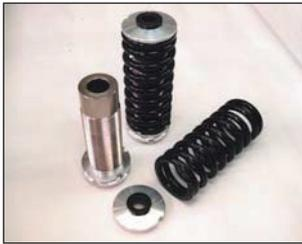
※純正のパネの受け皿を削り取り、車高調アジャスターをかぶせるだけで使用できます。
