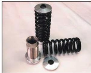
※車高を下げる時に問題になる底突きが解消でき簡単にショートストラットが完成します。
