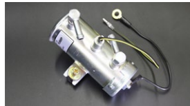
●ミツタイプ フューエルポンプ ¥17,000 *吐出量 1.4L/分 *最大吐出圧 0.3kg/cm 2 *キャブ専用の低燃圧タイプ、フューエルレギュレーター無しで使用可能。
