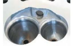
通常のシートカットと違い突き出し基準点をスプリングシート座面でなくカムシャフトセンター（L型はヘッド上面）基準で行う高精度なシートカット。バルブステム高さがカムシャフトに対し真っ直ぐに揃うことで燃焼室容積や、L型ではレバー比及びバルブのバラツキも抑えられる。
