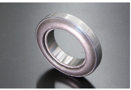
日産クラッチリリースベアリング 品番: 451S ¥4,370 ■適合 (標準) S20 G7 ※サイズ D=74 d=45 T=18 B=15 C=55
