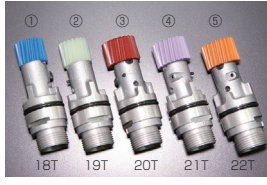
スピードメーターギヤ (71B/71C) 注記)71Bは下側固定タイプに適合。 ①18T(青) ¥1,400 ④21T(紫) ¥2,070 ②19T(白) ¥1,400 ⑤22T(橙) ¥2,070 ③20T(赤) ¥1,400
