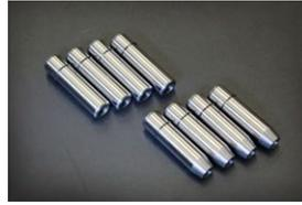
ノーマルオーバーホールやヘッドチューンなどに使用できるスタンダードバルブガイドです。日産純正品とは異なり内径外径が標準サイズに既に仕上げられており、内外径研磨の余計な加工費用がかかりません。最後に多少リーマを通してクリアランスを微調整するだけで完了です。
