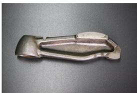
カムの当たり面に段付き摩耗を発見したら、直に交換が必要です。摩耗が進行するとカムシャフトのカム山を攻撃してしまい、損傷が大きくなります。
