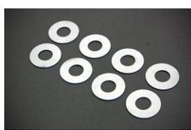
段付きシートの下側に敷くことによりバルブスプリングの取付長さを微調整できます。バルブスプリングに定められた最適な取付け長さを狙うことでセット荷重とフル荷重をベストに保つことができます。
