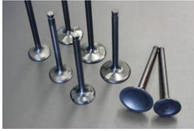
形状及び寸法を純正同等に再現し、材質や熱処理の仕様を耐久性重視の強化仕様に仕上げました。
