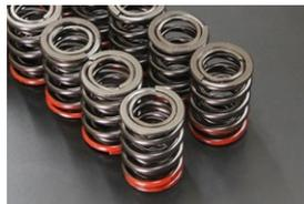
カムリフト9mmまで対応する強化バルブスプリングです。必ずバルブスプリング段付きシートと組み合わせてください。
