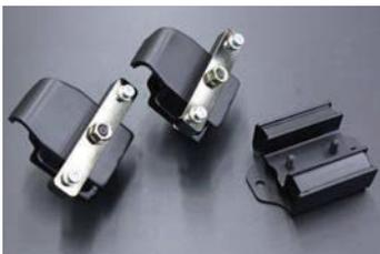
FJ20 特有のエンジン振動は、エンジンやキャブレターに悪影響を与えるだけでなく、シフトレバーにまで振動が伝わることでシフトフィーリングをも狂わせてしまいます。この強化マウントは適度に振動吸収でき走行安定性を整へ、エンジンパワーを無駄なく駆動系に伝えることができます。
