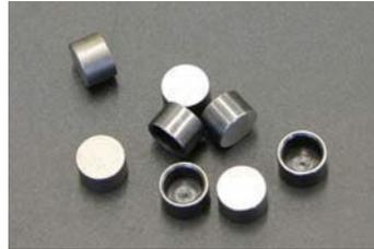
市販のバルブクリアランス調整用のバルブキャップは、最大厚みで2.65mmまでです。ノーマルカム加工によって細くなったカムを使用する場合にはバルブキャップの上に更にアウタークリアランスキャップを被せることでクリアランス調整が可能になります。
