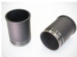
ライナーの外径、高さ及び各寸法は純正同サイズで製作されています。ブロック側は無加工で取り付けできます。ライナー内径寸法は81.7mmのセミ仕上げになっており、ポーリングによって82φのスタンダードサイズから使用が可能です。
