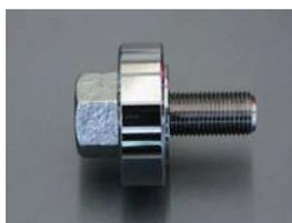
高回転時に発生するクランクシャフトのネジレ振動や曲がり振動は、ブリーボルトに大きな負荷を与えるためにボルト緩みに至ることがあります。それにより、クランク先端のカジリやブリートラブル、オイル漏れ等に被害が及ぶ恐れがあり大変危険です。強化ブリーボルトはロングボルトと強化ワッシャーによってボルトの緩みを防止します。
