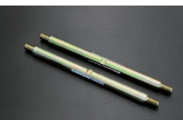
S30 リアロアームスピンドル ¥2,540/1本 ・ロアームブッシュの交換時に 固着したスピンドルを交換 ※別売り ロックボルト ¥1,390/1本
