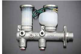
GC110 ブレーキマスターシリンダー サイズ: 7/8 (日産純正ナブコ製) 適合: GC110後期型, GC111 (リヤドラム車 75.10~77.7) 価格: ¥79,000
