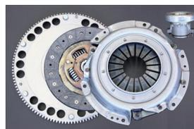
U20 標準クラッチサイズの 200φに対し、225φビックサイズクラッチとクロモリ軽量フライホイールを組合せた高性能タイプ。圧着力 550K のクラッチカバーとノンアスディスクの組合せで、純正以上の快適操作が可能なストリート向けのハイパフォーマンスクラッチキットです。
