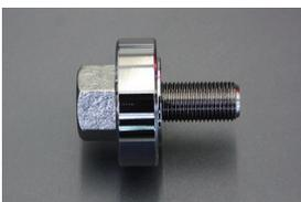
高回転時に発生するクランクシャフトのネジレ振動や曲がり振動は、プリーボルトに大きな負荷を与えるためにボルト緩みに至ることがあります。それにより、クランク先端のカジリやプリーボルトトラブル、オイル漏れ等に被害が拡大する恐れがあり大変危険です。強化プリーボルトはロングボルトと強化ワッシャーによってボルトの緩みを防止し、大切なエンジンをトラブルから守ります。
