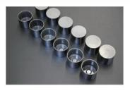
動弁系の軽量化に大きなウエイトを占めている のがバルブリフターです。充分な強度を持つク ロモリ鋼の使用で肉厚を抑え大幅な軽量化を 実現!また、外周面の長さをロングに設計する ことでリフターの首振りを抑え、カムプロフィー ルに対し正確に追従させることができカムシャ フト本来の性能をフルに発揮できます。
