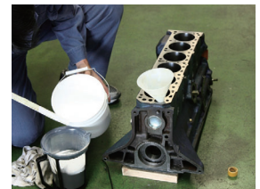
※ブロックフィラー作業順序 1 ブロックフィラーと硬化剤を1対1の割合で混ぜる。
