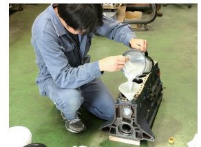
※ブロックフィラー作業順序 2 ブロックを水平に置いてジョーグを使いリヤ側のウォータージャケットホールからブロックフィラーを流し込む。
