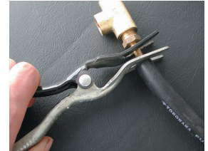
■ホースリムーバ 2,800円 抜けないホースを簡単に抜きとれる便利なツール。バキュームホースからヒーターホースまで使用可能。
