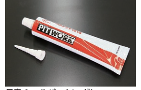
日産 シールパッキン グレー エンジン、ミッション、デフの組み立て用 に使用できる液体ガスケット。 塗布後約30分ぐらいで固まりはじめる 価格：¥3,300
