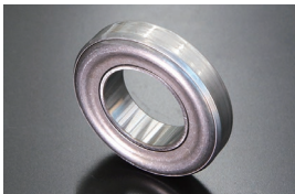
日産クラッチリリースベアリング 品番: 40751S ¥1,910 ■適合 (標準) L6 A型 FJ20 ※サイズ D=74.5 d=40 T=19 B=17 C=62
