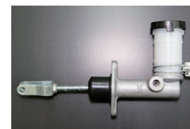
5/8クラッチマスターシリンダー 適合 : KPGC10, PGC10 (GT-R用) サイズ: 5/8 価格 : ¥23,000 (2025.7.21 追加)
