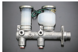
KHC130 ブレーキマスターシリンダー サイズ: 7/8 (日産純正ナブコ製) 適合 : リヤドラム車 (L20) (75.10~80.10) 価格 : ¥88,000 (更新 2026.06.04)
