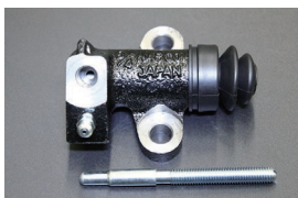
手動調整 3/4リレズシリンダー 適合: GC10/S30前期 サイズ: 3/4 価格: ¥8,710 (2025.4.13 更新)
