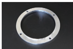
L6用 カップリングファンセーサー ※ファンを前方に8mmオフセットさせるパーツ ・厚み...8mm ・付属品...ロングボルト4本 ・価格: ¥4,600
