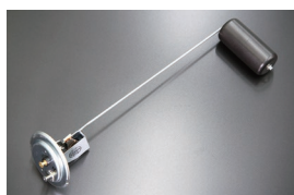
S30前期フューエルタンクユニットゲージ
