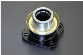
Z31やR31のR200を、ハコスカやS30に載せるのに必要なコンパニオンフランジです。狭いスペースでのデフの脱着で、作業性を悪くしていた従来の丸型フランジを角型形状に設計変更したことで、作業性改善に役立ちました。また、肉厚仕様設計で耐久性も充分に確保しています。
