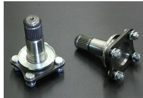
・S30やGC10に入手が容易なスバルのR180デフを装着できるボルトオンサイドフランジです。日産R180のボルトタイプ(中空スプライン)とは異なり、サークリップタイプであるためスプライン内部を中空にする事ができ強度を上げられます。更にスプラインの直径が2mm太い強化タイプであることに加え、高強度ニッケルクロムモリブデン鋼の採用により純正比2倍の強度を確保しました。
