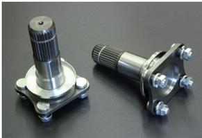
・エンジンのパワーアップに伴いR180からR200へのデフ交換はチューニングカーの定番。その際に必ず必要になるのが、このサイドフランジです。日産純正サイドフランジの製造廃止をきっかけに、強化パーツとして見直しをかけ、設計変更を行いました。急激なクラッチミートにおける衝撃やネジしに耐えるため材質にニッケルクロムモリブデン鋼を採用し、熱処理や加工精度の厳しい検査基準をクリアしています。
