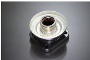
SUBARU R180を、ハコスカやS30に載せる際にあれば便利なコンパニオンフランジです。狭いスペースでのデフの脱着で、作業性を悪くしていた従来の丸型フランジを角型形状に設計変更したことで、作業性改善に役立ちました。
