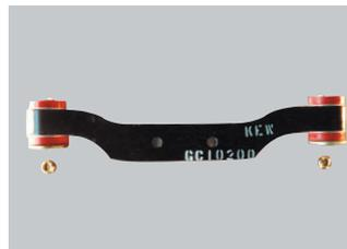
7mm厚のSUP6材を使用し板バネ形状に設計変更を施したR200専用の強化メンバーです。ウレタンブッシュとの組み合わせにより適度な振動吸収を可能とし、大幅な強度アップを実現しました。
