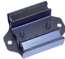
純正比1.5倍に硬度設定した強化ゴム使用でミッション及びシフトレバーに伝わる振動を適度に吸収できスムーズなシフトチェンジが可能になります。
