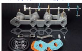
1009 (ピロリンゲージ式) T, 2T, 12T, 13T 13T系はデストリビューター交換要 ¥57,000 ※インマニガスケットとフューエルホースは別売りです。
