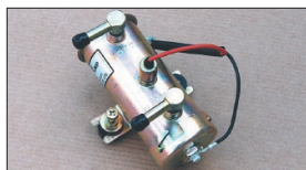
●ニスモ フューエルポンプ 本体 ¥15,000 *吐出量 1.3L/分 *最大吐出圧 0.45kg/cm 2 *キャブ車専用の高燃圧タイプ。フューエルレギュレーターで圧力調整必要。
