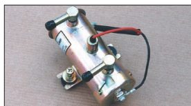
●ニスモ フューエルポンプ 本体 ¥11,500 *吐出量 1.3L/分 *最大吐出圧 0.45kg/cm 2 ※キャブ車専用の高燃圧タイプ。フューエルレギュレーターで圧力調整必要。
