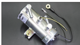
●ミツタイプ フューエルポンプ ¥17,000 *吐出量 1.4L/分 *最大吐出圧 0.3kg/cm 2 ※キャブ車専用の低燃圧タイプ。フューエルレギュレーター無しで使用可能。
