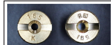
●SOLEX メインジェットの種類と違い 設定 #125~#290 設定 #100~#240
