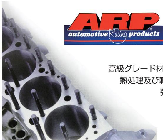
高級グレード材の8740クロモリ合金をベースに、厳しい検査基準によって熱処理及び転造処理をクリアし、200000psiの引っ張り強度を持つ強化ボルトです。更にスタッドボルト化により、ネジ山全体で力を受けやすいため、シリンダーボアの変形を1/2に抑えられピストンの当りを良好にできます。
