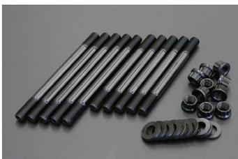
アメリカ ARP 社で設計されたスタッド式ヘッドボルトです。200000PSI の強度規格を持ち、十分な引っ張り強度を確保できます。また、スタッドボルトの採用でヘッドボルトの締め付けによるシリンダーボアの変形を1/2に抑えられピストンクリアランスの安定化を図れます。
