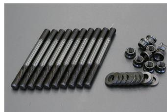
アメリカ ARP 社で設計されたスタッド式メインボルトです。十分な引っ張り強度を生かし、高回転におけるクランク振動を押さえ込み、4AG エンジンの高回転化を可能にします。また、スタッドボルトの採用によってメインボルトの締め付け力増大によるハウジング変形を最少に抑えられ、メタルクリアランスへの悪影響を軽減します。
