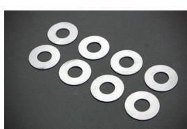
段付きシートの下側に敷くことによりバルブスプリングの取付長さを微調整できます。バルブスプリングに定められた最適な取付け長さを狙うことでセット荷重とフル荷重をベストに保つことができます。
