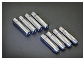
ノーマルオーバーホールやヘッドチューンなどに使用できるスタンダードバルブガイドです。日産純正品とは異なり内径外径が標準サイズに既に仕上げられており、内外径研磨の余計な加工費用がかかりません。最後に多少リーマを通してクリアランスを微調整すだけで完了です。
