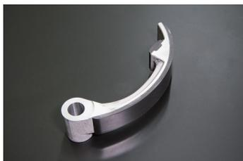
純正比1.5倍の引張強度を持つ強化品です。高回転時に発生するタイミングチェーンのバタツキ(衝撃)によるクラックトラブルを防ぎます。
