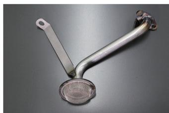
DR30車に起きやすいとされるトラブルがオイルパンの底突きです。それにより、ストレーナーの網が潰されてオイルが十分に供給できないことがあります。この製品は、製造廃止になっているオイルストレーナーを補強を充実させ強化タイプとして復刻しました。
