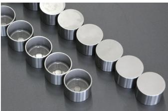
高強度設計は勿論のこと、外径寸法を純正値より多少太めに設計する事により、リフターのガタを抑えました。それにより、カムシャフトのプロフィールをロスなくバルブに伝えることができ、タペットノイズを減らし本来のエンジン性能を取り戻します。
