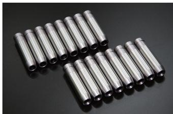
レース用バルブガイドを必要としないノーマルオーバーホールやヘッドチューンなどに使用できる鋳鉄製スタンダードバルブガイドです。純正品のように外径オーバーサイズで内径半加工品とは異なり、内外径が既にSTDサイズに仕上げられており、余計な加工費がかりません。最後にリーマを軽く通してクリアランスを微調整だけで完了です。
