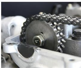
製造廃止だったロックワッシャーの復刻品です。センターボルトのロックワッシャーは、ツバの折り曲げによりボルトの緩みを防止し高回転での安全性を高めます。
