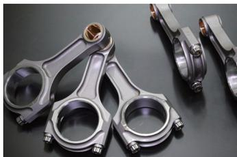
クロムモリブデン鋼による削り出し軽量I型断面形状によってコンロッド強度を大幅に改善しました。コンロッドボルトには信頼性の高い米国ARP社製のレース用ボルトを使用し高回転におけるボルトトラブルを防ぎます。また、全体重量を約548gの軽量設計したことで遠心力によるクランクメタルへの負担を低減し高レスポンスを可能にします。
