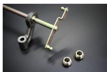
すり減ったボールジョイントのままでは、スロットル開度が不安定になり、どんなにキャブ調整を行っても同調が取れません。このボールジョイントは、摩擦に強いアルミ製鋼の採用とオーバーサイズ設計によって、アクセルリンケージの軸部の振れを0.05位内に安定させ、キャブの同調を整えることができます。
