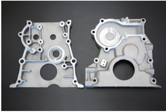
S20フロントカバーはウォーターポンプ周りの腐食やドリブンギヤベアリング支持部に亀裂損傷などが起きやすく修理が難しいパーツです。この複製品はベアリング挿入部に鋼材を使用し耐久性を重視した設計を施してあります。
