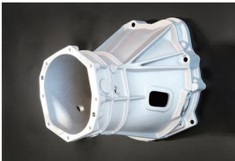
純正71Aミッションはオーバーホール部品の殆どが製造廃止のため修理ができません。このハウジングはGC210やS130の71Bミッションにハウジング交換することで71Bを搭載することができます。更に、多少の加工を加えることで71Cに変更することもでき、クロスミッションやクイックシフトの組み合わせを可能とします。(71Bにもクロスミッションの設定はあります)
