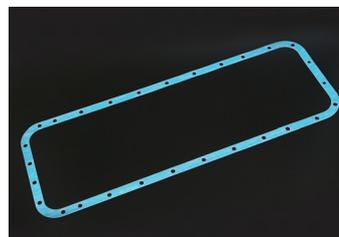
連続使用400度に対応! 耐熱、耐油に優れたセラミック繊維素材採用の強化ガスケットです。純正のコルク製品とは異なり、締め付けによるガスケットの潰れやほみ出しが発生せず、締め付けトルクを上げられます。
