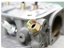
A型特有のインチネジをM16xP1.5に変換できるセンサーアダプターです。これにより、社外品の機械式水温計センサーをラジエーターホースに割り込ませることなく、本来の位置に装着することができます。
