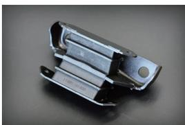
純正比1.5倍に設定した強化ゴムの使用により、ミッションからシフトレバーに伝わる振動を強化ゴムが適度に吸収し、シフトチェンジの操作性を向上させます。
