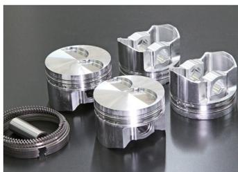
耐久性に実績のある鍛造素材をベースに、可能な限り軽量を追及した総削り出しピストンです。7mmトップランドのフラット設計に加え、IN,EX共に4.5mmに彫り込んだバルブリセスによりバルブリフトカムシャフトに対応。更に精円率の変更やスカート形状の変更などレースに要求される耐久性及び高性能が設計に盛り込まれています。
