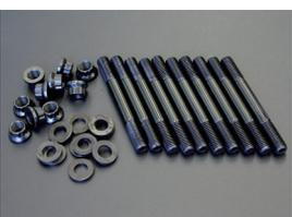
アメリカ ARP社で設計されたスタッド式メインボルトです。充分な引っ張り強度を生かし、高回転におけるクランク振動を抑え込み、A型エンジンの高回転化を可能にします。また、スタッドボルトの採用によってメインボルトの締め付け力増大によるハウジング変形を最小に抑えられ、メタルクリアランスの安定化を図れます。
