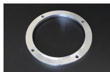
L型車のファンはオフセットに種類があります。エンジン側に寄っているタイプのファンでは、ファンがダンパープーリーのボルトに干渉する恐れがあります。このスペーサーはカップリングとファンの間に挟み込むことで羽の部分だけを前に8mmオフセットする事ができ干渉を防ぐことができます。
