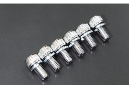
クラッチカバー強化ボルト6本SET (締付トルク：4.0kg/m 39.2N・m) 適合：L6(225mm) L18, FJ20(NA) L20B, A型, 2TG, 18RG, 4K 価格： ¥1,500 ※腐食に強いクロムメッキ仕上げ
