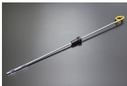
S130 オイルレベルゲージ ※上部からHまでの距離179mm HからLまで19mm 価格： ¥700 (2026.4.6更新)
