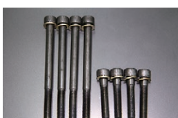
L4 カムホルダー強化ボルトSET ※多少長めの設定でネジ山を濡めづらい M8×100 締付：2.5kg/m(24.5N・m) M8×40 締付：2.2kg/m(21.5N・m) 価格： ¥1,800
