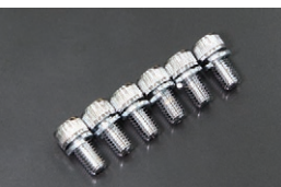
クラッチカバー強化ボルト6本SET (締付トルク：4.0kg/m 39.2N・m) 適合：L6(L225mm) L18, FJ20(NA) L20B, A型, 2TG, 18RG, 4K 価格： ¥1,500 ※腐食に強いクロムメッキ仕上げ
