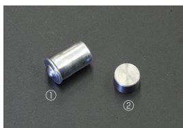
L型 オイルリリーフバルブ&プラグ ①リリーフバルブ ¥350 ※標準装備品でフィルターの目詰まり時のリリーフ回路のバルブ ②リリーフプラグ ¥800 ※高圧圧縮回転でもリリーフさせず、確実にフィルターを通す
