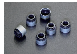
L型 ローヘッドバルブオイルシール ¥280/1ヶ 純正品より1.3mm 高さが低いタイプ。底付きまでの距離をかせて、バルブリフトをあげられる。
