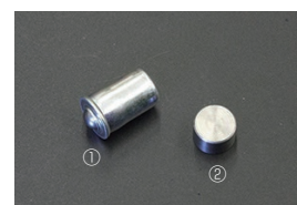
L型 オイルリリーフバルブ&プラグ (2026.4.6更新) ①リリーフバルブ ¥370 ※標準装備品でフィルターの目詰まり時のリリーフ回路/バルブ ②リリーフプラグ ¥800 ※高油圧高回転でもリリーフさせず、確実にフィルターを通す
