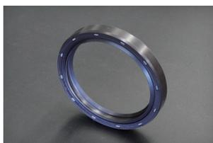
レース走行やそれに等しい運転をされる場合、標準のリヤオイルシールではシール性に対し既に限界といえます。この強化オイルシールは、奥行きが日産純正品の8.5mm、亀有標準品の10mmに対し、13mmの奥行きを持ち外周面に強い圧入を得ることができます。更に内側のクランク軸を締め付けるスプリング強度やゴム厚みに対しても変更を加え、内外ともに万全のオイル漏れ対策が施されています。
