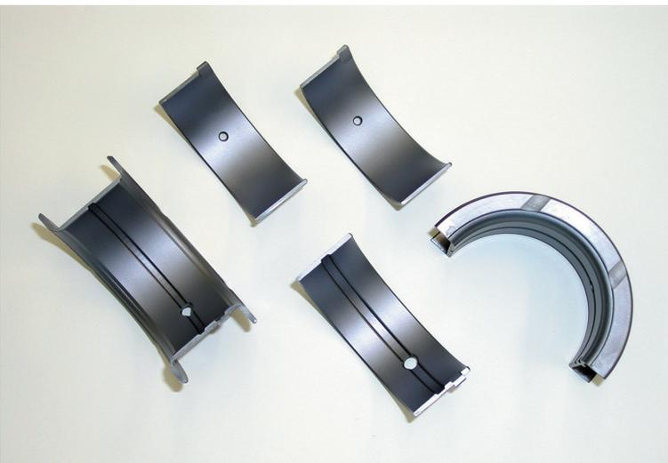
従来品のNISMOメタルをベースにメタル表面に特殊な表面処理を施した強化メタルです。一般的なWPC処理とは違い、固体潤滑剤として良く知られている二硫化モリブデン粉末を直接噴射することで、メタルの表面組織内に固体潤滑剤が拡散浸透すると同時に表面に微細な凸凹を成形して油膜保持効果を高めます。
