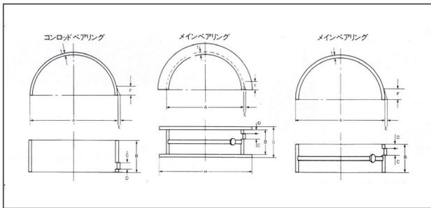
高荷重高回転に対応させる為に高強度F112材を採用したニスモレース用メタルです。オイルの潤滑性を上げる為メインメタルには上下共にオイル溝を設け耐焼付き性を高めています。
