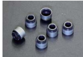
L型 ローヘッドバルブオイルシール ¥270/1ヶ 純正品より 1.3mm 高さが低いタイプ。底付きまでの距離をかせげて、バルブリフトをあげられる。
