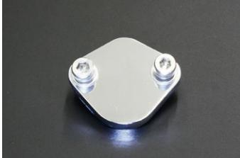
標準のメカニカルフューエルポンプを取り外し、電磁ポンプに変更するときに必要になるカバーです。
