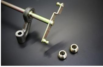
すり減ったボールジョイントのままで、スロットル開度が不安定になり、どんなにキャップ調整を行っても同調が取れません。このボールジョイントは、摩耗に強いアルミ製鋼の採用とオーバーサイズ設計によって、アクセルリンクージの軸部の振れを0.05mm以内に安定させ、キャップの同調を整えることができます。
