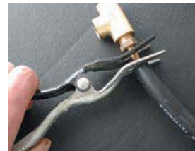
■ホースリムーバ 2,800円 抜けないホースを簡単に抜きとれる便利なツール。バキュームホースからヒーターホースまで使用可能。
