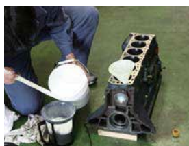
※ブロックフィルター作業順序 1 ブロックフィルターと硬化剤を1対1の割合で混ぜる。
