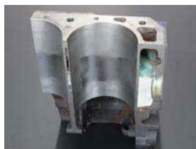
※ブロックフィルター作業順序 3 注入量は目的により異なります。ドラッグレースは上面から80~85mm、周回レースは90~95mmくらいが目安です。ブロックフィルターを入れた分だけ冷却水の容量が減り水温や油温に影響を与えるので目的に応じた量が必要です。
