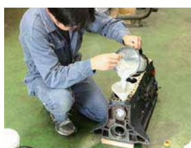
※ブロックフィルター作業順序 2 ブロックを水平に置いてジョーゴを使いリヤ側のウォータージャケットホールからブロックフィルターを流し込む。
