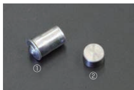
L型 オイルリリーフバルブ&プラグ ①リリーフバルブ ¥300 ※標準装備品でフィルターが目詰まり時のリリーフ回路(リレフ)を確保 ②リリーフプラグ ¥800 ※高油圧高回転でもリリーフさせず、確実にフィルターを通す
