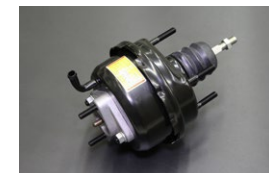
GC110 前期マスターパック サイズ：外径143φ (ツメ部) ※スパーサー使用でハコスカ流用可 価 格：¥20,600
