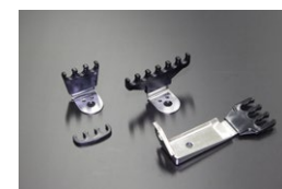
L6 プラグコードホルダーセット (クロムメッキ) 適合：支柱は2本ボルトサーモカーパー用 価格：¥8,000/set
