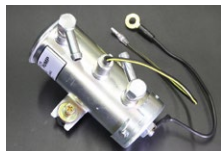
●ミツバタイプ フューエルポンプ 本体 ¥13,500 *吐出量 1.4L/分 *最大吐出圧 0.3kg/cm 2 *キャブ車専用の低燃圧タイプ、フューエルレギュレーター無しで使用可。
