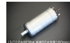
(入口12φ出口8φ 本体52φ全長180mm) ●2.6Lポッシュフューエルポンプ 本体 ¥28,600 *吐出量 2.6L/分 (L28~L32ストリート向け) *大容量フューエルレギュレーター1個と8mmリターンパイプ1本で燃圧制御可能
