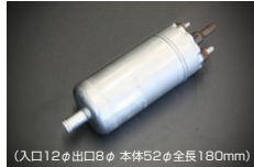
(入口12φ出口8φ 本体52φ全長180mm) ●3.1Lポッシュフューエルポンプ 本体 ¥55,500 *吐出量 3.1L/分 (L30~L32レース用) *大容量フューエルレギュレーター2個と8mmリターンパイプ2本で燃圧制御可能
