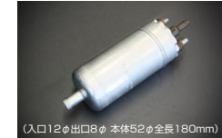
(入口12φ出口8φ 本体52φ全長180mm) ●2.6Lポッシュフューエルポンプ 本体 ¥28,600 *吐出量 2.6L/分 (L28~L32ストリート向け) *大容量フューエルレギュレーター1個と8mmリターンパイプ1本で燃圧制御可能
